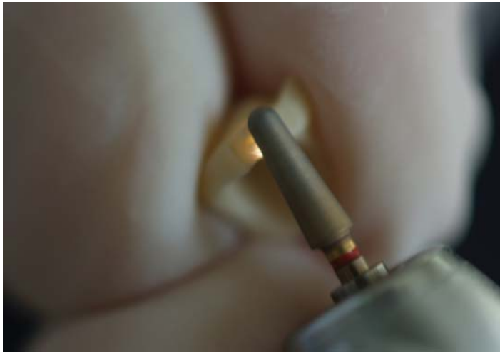
Fig.10 Si se retoca el óxido de zirconio con turbina se puede observar como saltan continuamente chispas, lo que indica las altas temperaturas que se generan. Esto puede provocar la transformación del óxido de zirconio de la fase tetragonal a la monoclinica
